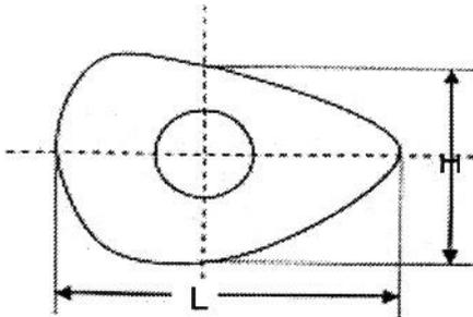
L' altezza dello spot è la distanza tra il bordo superiore ed il bordo inferiore misurata sulla retta verticale passante per il centro del superspot (H)
